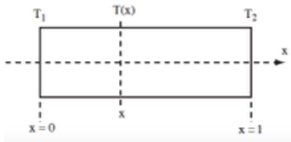
On suppose dans un premier temps la surface latérale parfaitement calorifugée.
