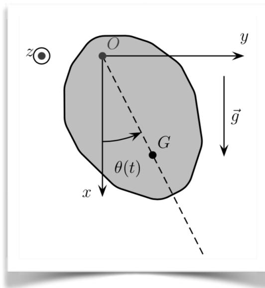
Figure 1 - Schéma du pendule sans ressort de rappel
