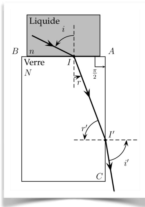
Figure 1 : réfractomètre de Pulfrich
