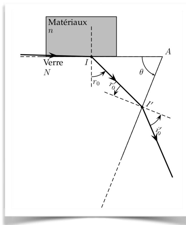
Figure 2 : réfractomètre d'Abbe
