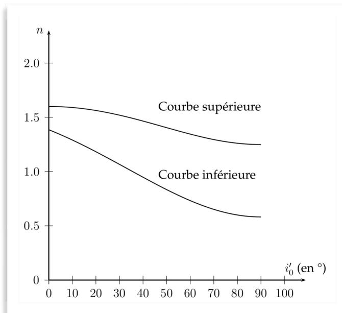
Figure 3 : Courbes donnant  $n(i'_0)$  pour les deux réfractomètres
