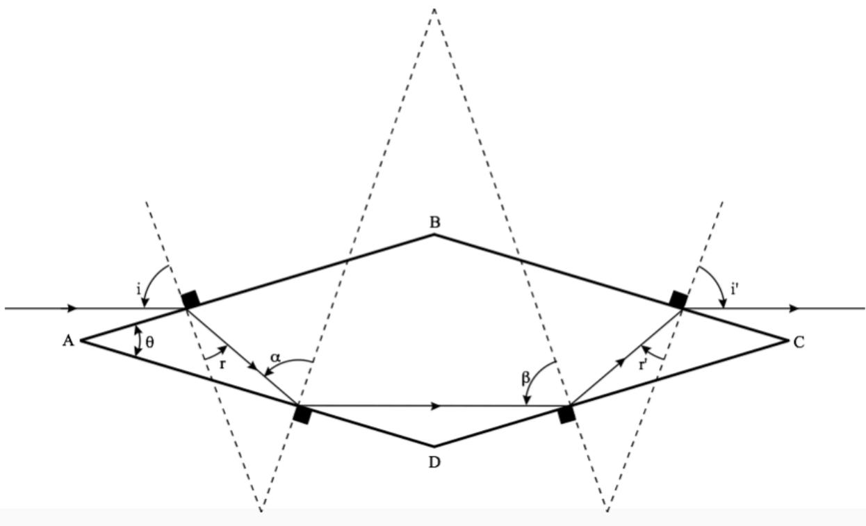
Figure 1 : Marche d'un rayon traversant le prisme
