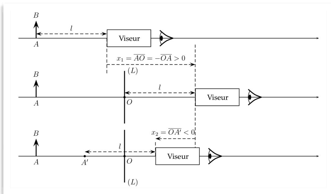
5.1. Sur la figure, on lit directement  $\overline{OA} = -x_1 = -20 \text{ cm}$  et  $\overline{OA'} = -x_2 = -10 \text{ cm}$ .
